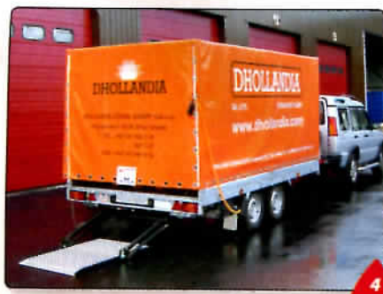
4. Alváz alá csúsztató emelőhátfal kisteherautóhoz vagy kis pótkocsihoz 5. Alváz alá hajtott emelőhátfal 6. Hátsó ajtó helyére szerelt rámpa
