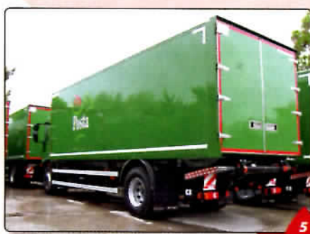
4. Alváz alá csúsztató emelőhátfal kisteherautóhoz vagy kis pótkocsihoz 5. Alváz alá hajtott emelőhátfal 6. Hátsó ajtó helyére szerelt rámpa
