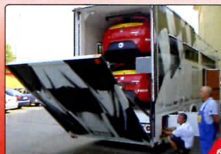
4. Belülre szerelt emelőhátfal furgonhoz 5. Belülre szerelt emelőgép hordós áruhoz 6. Versenyautó-szállító emelőhátfal többszintes emelési képességgel
