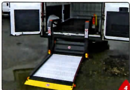
4. Belülre szerelt emelőhátfal furgonhoz 5. Belülre szerelt emelőgép hordós áruhoz 6. Versenyautó-szállító emelőhátfal többszintes emelési képességgel
