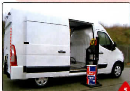
4. Belülre szerelt emelőhátfal furgonhoz 5. Belülre szerelt emelőgép hordós áruhoz 6. Versenyautó-szállító emelőhátfal többszintes emelési képességgel
